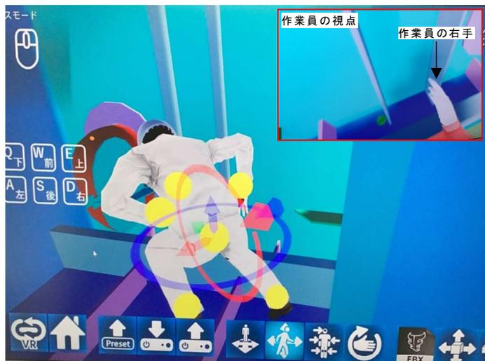
図-3 VRを用いた支点近傍での作業姿勢の確認
