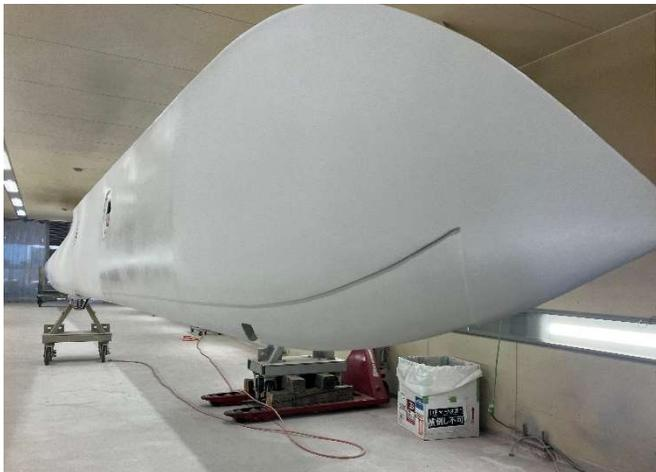
写真-7 エロージョンテストセクション製作
