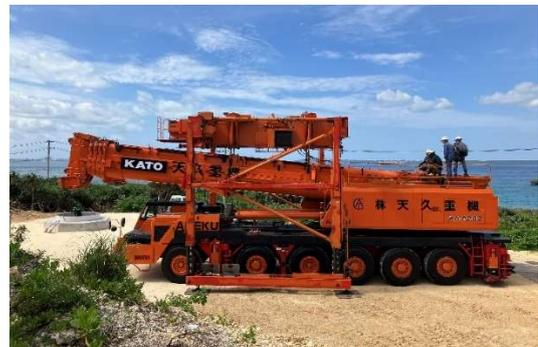
写真-2 リフターによるクレーン組立
