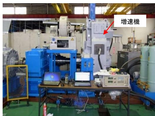
写真-3 増速機負荷試験状況
