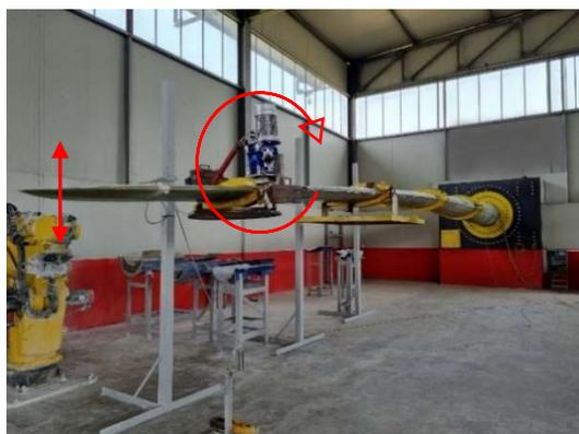
写真-2 ブレード疲労試験
