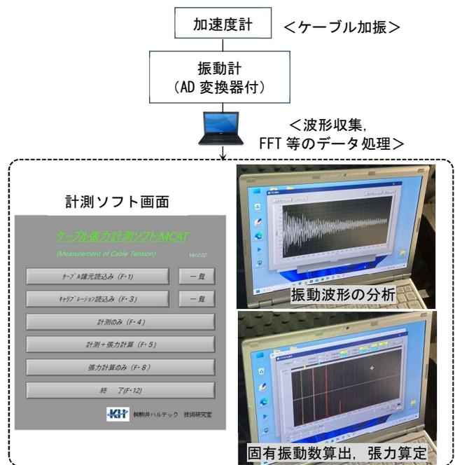
図-1 張力計測システム概要図
