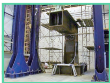
鋼製橋脚疲労実験
