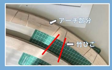
ケーブルとなる竹ひごを板の間 に挟むことで、接着長を増やし、 抜けづらくする
