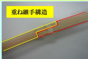
工夫点:部材長に制限があるため、重ね継手構造を採用することで、スパン1mのアーチ部材を製作することができました。
