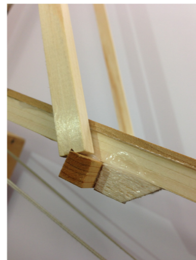
◆ プレテンション導入用仮設材の工夫
