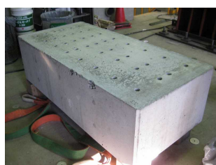
写真-9 抜取り試験体
