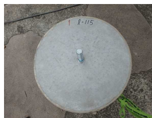
写真-2 引抜き前試験体
