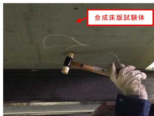
写真-8 試験体たたき検査状況
