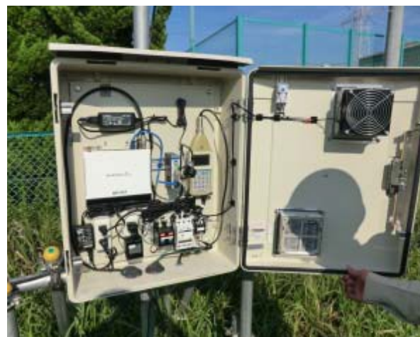
写真-4 騒音計測ボックス内部
