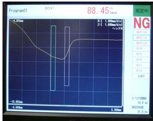
図-11 アンダーカット底の角度測定
