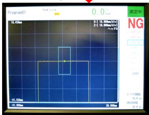
図-13 食い違い・ずれの測定手順 (エリア設定)
