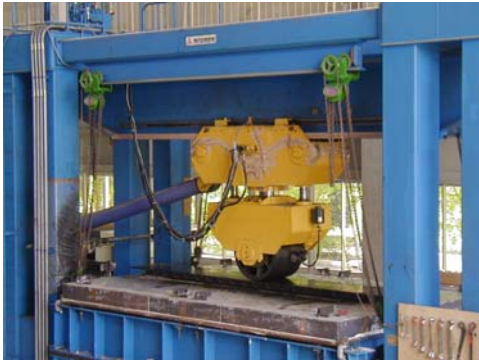
写真-1 パイプスラブ輪荷重走行試験状況
