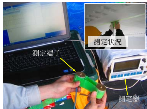
写真-3 横波振動法測定器と測定状況
