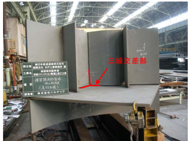
写真-1 溶接施工試験体
