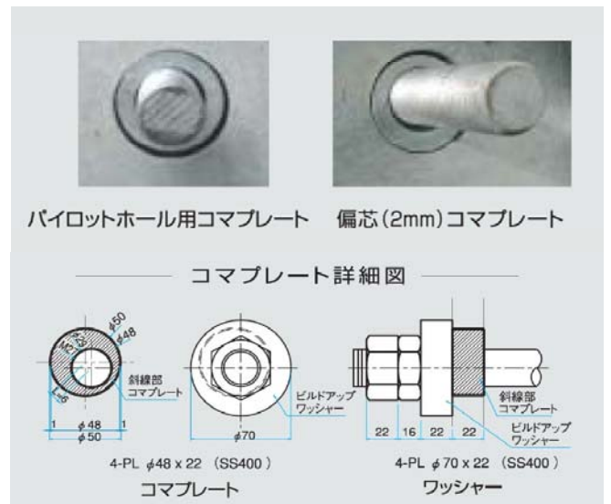
図-3 「コマプレート」および拡大ワッシャーの詳細図
