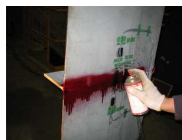
設置状況 (Type-B) 浸透探傷 (Type-A) 写真-1 試験状況
