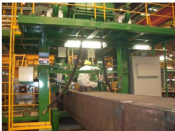
写真-3 サブマージアーク溶接機
