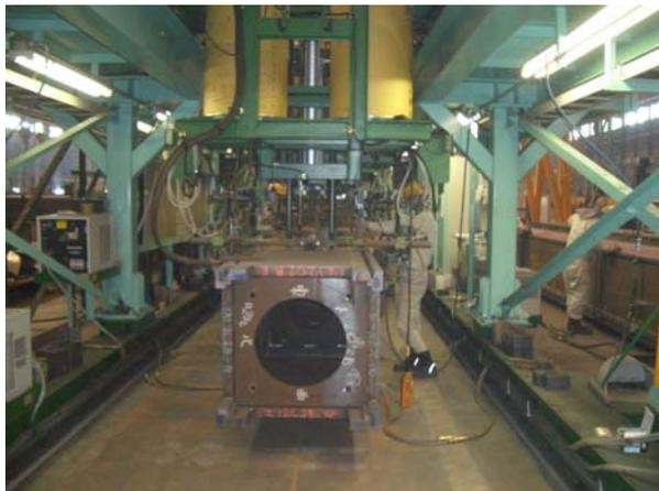
写真-4 エレクトロスラグ溶接機移動台車
