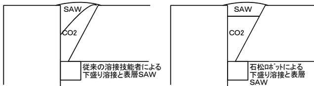
図-4 下盛りCO<sub>2</sub>表層SAW工法
