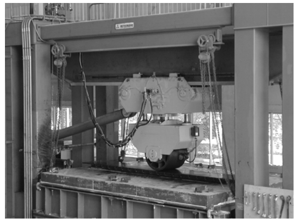
写真-2 輪荷重走行試験状況，独) 土木研究所於
