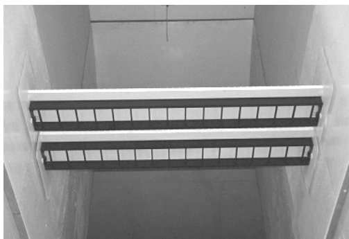
写真-1 風洞試験実施状況 (並列状態)
