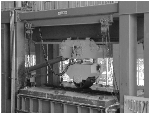
写真-2 輪荷重走行試験状況 (土木研究所於)
