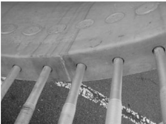
写真-7 アブキン・ラスマセン社製のブレード付根部
