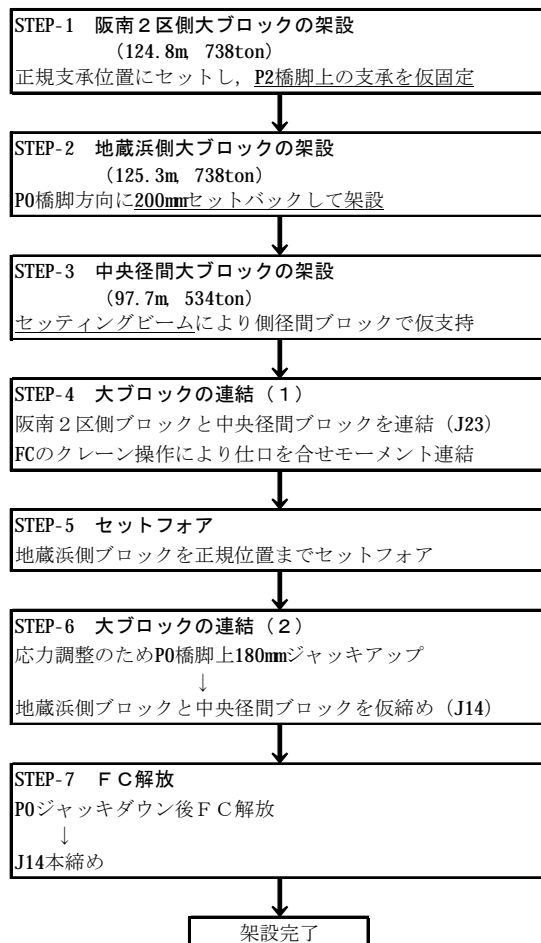
図-4 架設ステップ図
