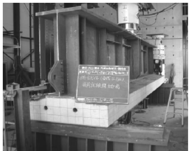
写真-4 合成桁の負曲げ試験
