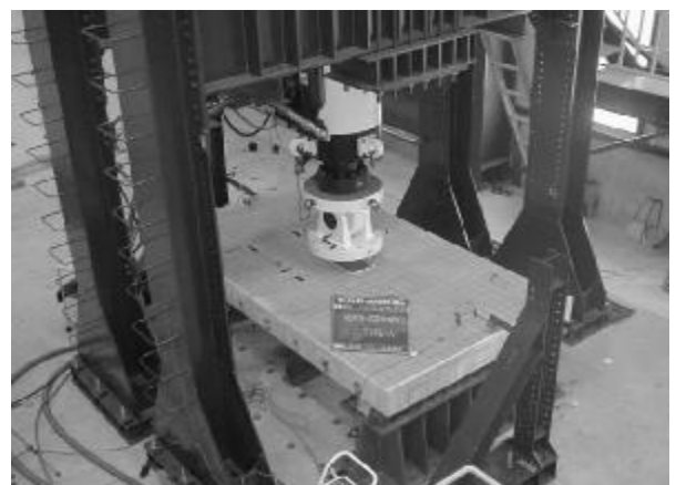
写真-2 試験状況 (版の曲げ試験)
