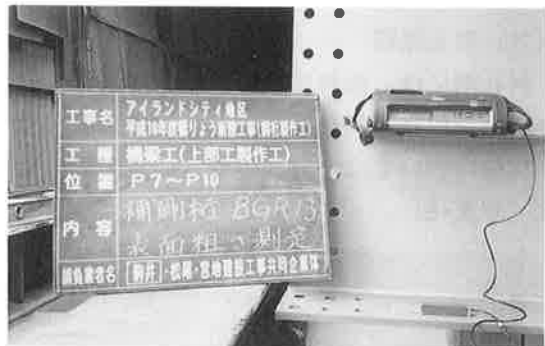
写真-4 ブラスト後の表面粗さ測定
