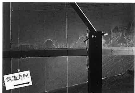
写真-6 模型側面の流れ ( B/D=2 , \beta=60^\circ ) V=0.90\text{m/s} , Re=3.1 \times 10^3 , f=2.3\text{Hz} , A/D=0.1
