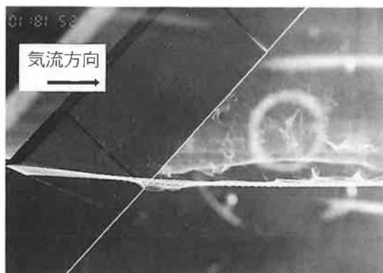
写真-2 模型上側面付近の流れの可視化 (一様断面, \beta = 45^\circ ) ( V = 1.24\text{m/s} , Re = 4.2 \times 10^3 )
