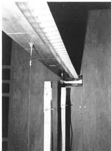
写真-2 橋梁断面模型
