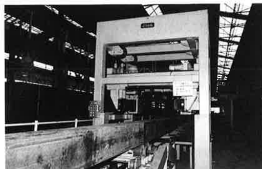
写真-8 エレスラ溶接終端部削成装置
