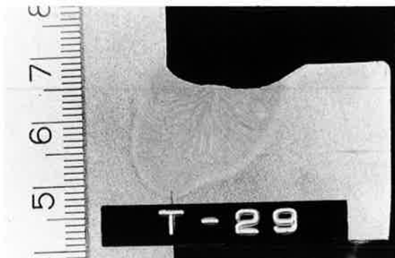
写真-1 目標とするビード横断面マクロ形状
