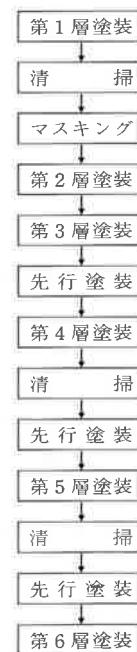
図-3 素地調整後の塗装作業工程
