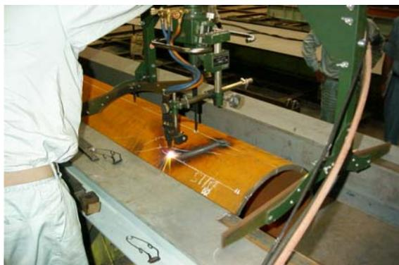
3. 鋼管ガセット部開先加工
