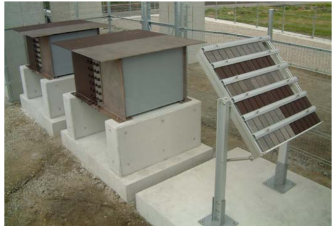
写真-2 試験体暴露状況
