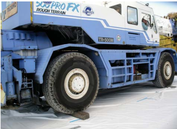
(b) クレーン車による加振
