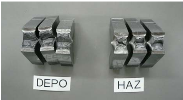
写真-7 衝撃試験片
