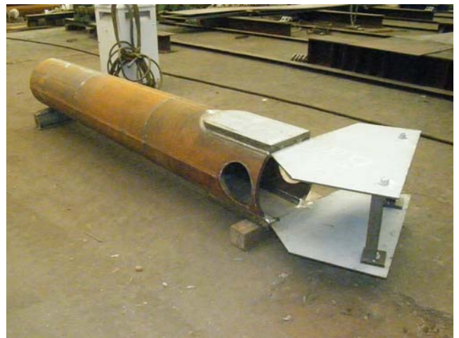
写真-2 Type1 45^\circ 試験体
