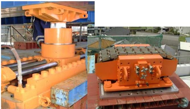
写真-1 送りジャッキ 写真-2 シンクロジャッキ
