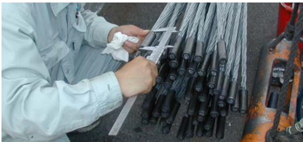
写真-5 圧着グリップの品質確認
