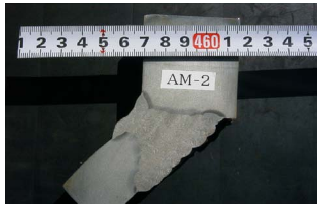
写真-4 二面ガセット溶接部マクロ
