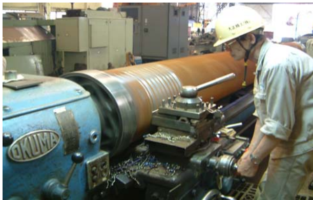
写真-6 二重管切削状況
